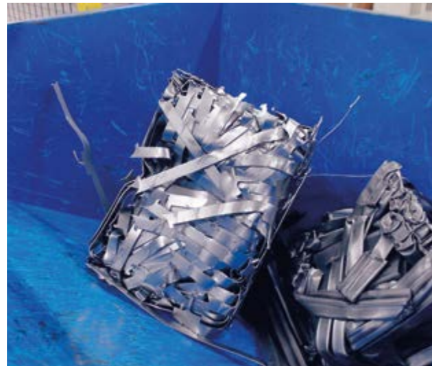
Gepresste Blöcke mit Stahlresten
